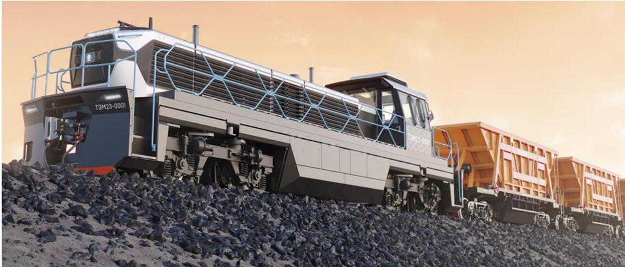
Тепловоз ТЭМ23 является односекционным двухдизельным четырехосным локомотивом с электрической передачей переменного тока модульной конструкции, состоящим из модуля главной рамы, с установленными модулем пневмооборудования, двумя модулями силовой установки, модулем холодильной камеры, модулем электрооборудования, модулем кабины управления башенного типа, вспомогательным модулем.
